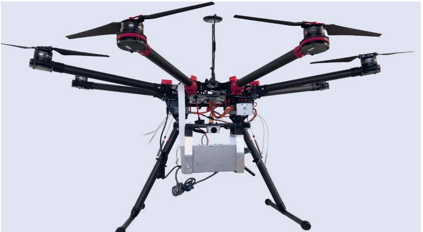
Abbildung 1: Dieses Bild zeigt das fertige UAV. Unten erkennt man in Grau die Elektronikbox, in der alle Sensoren und der Einplatinencomputer untergebracht sind. Quelle: Alexander Mistretta
