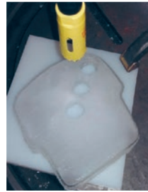
Abbildung 4: Probenbohrungen der Höhenschnitte
