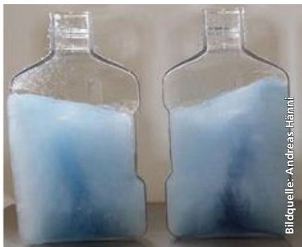
Abbildung 5: Eingefärbter Puffer einer aufgeschnittenen unverpackten Probenflasche (Höhenprofil)
